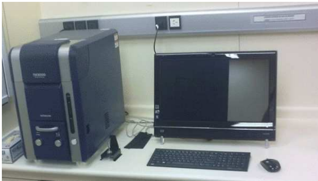
Figura 3.11 Microscópio eletrônico de varredura TM3000
