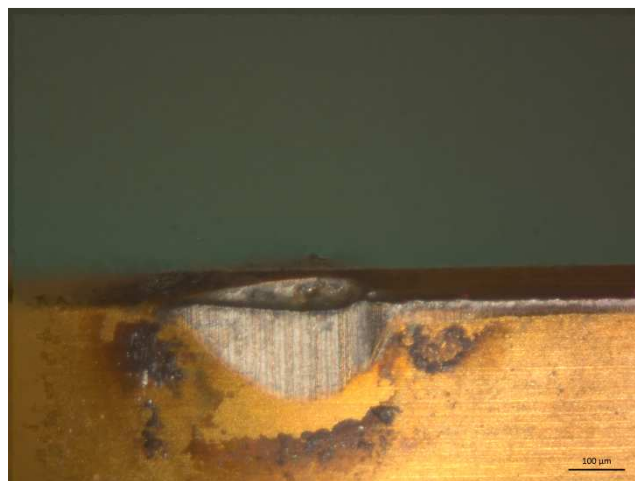
Figura 3.7 Desgaste da ferramenta utilizada durante teste com MQF na direção de folga principal
