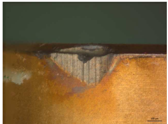
(e) V_c = 310 m/min; f = 0,05 mm/rev; a_p = 0,05 mm; VB_{Bmax} = 0,27 mm
