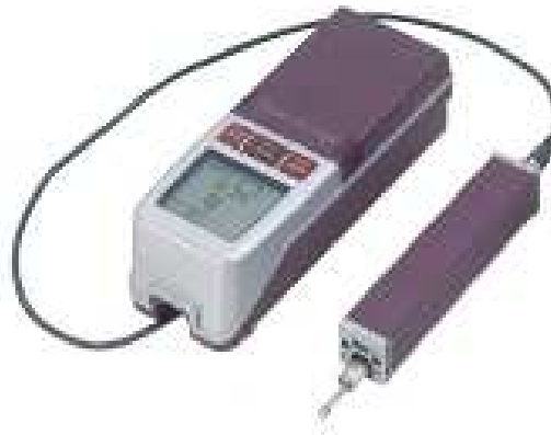
Figura 3.10 Rugosímetro Mitutoyo modelo SJ-201
