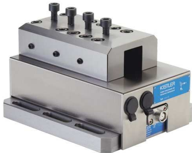
Figura 3.8 Dinamômetro Kistler® utilizado para medição das forças nos experimentos (KISTLER, 2013)
