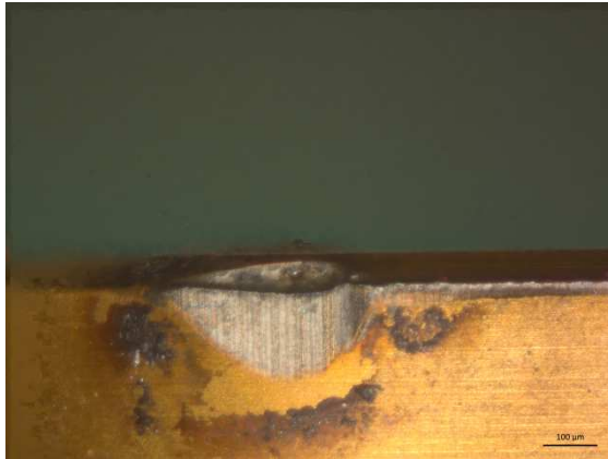
(a) V_c = 310 m/min; f = 0,05 mm/rev; a_p = 0,05 mm; VB_{Bmax} = 0,25 mm
