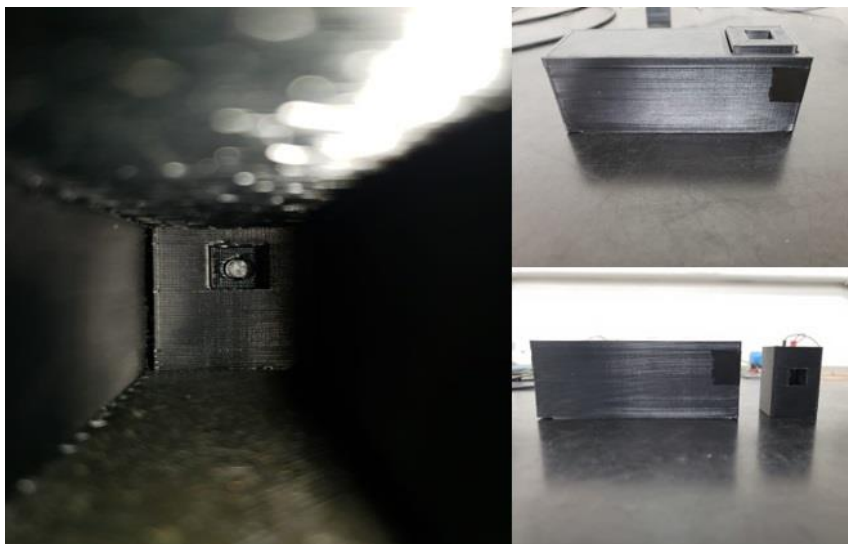
Figura 46. Suporte para obtenção das imagens utilizando smartphone.
