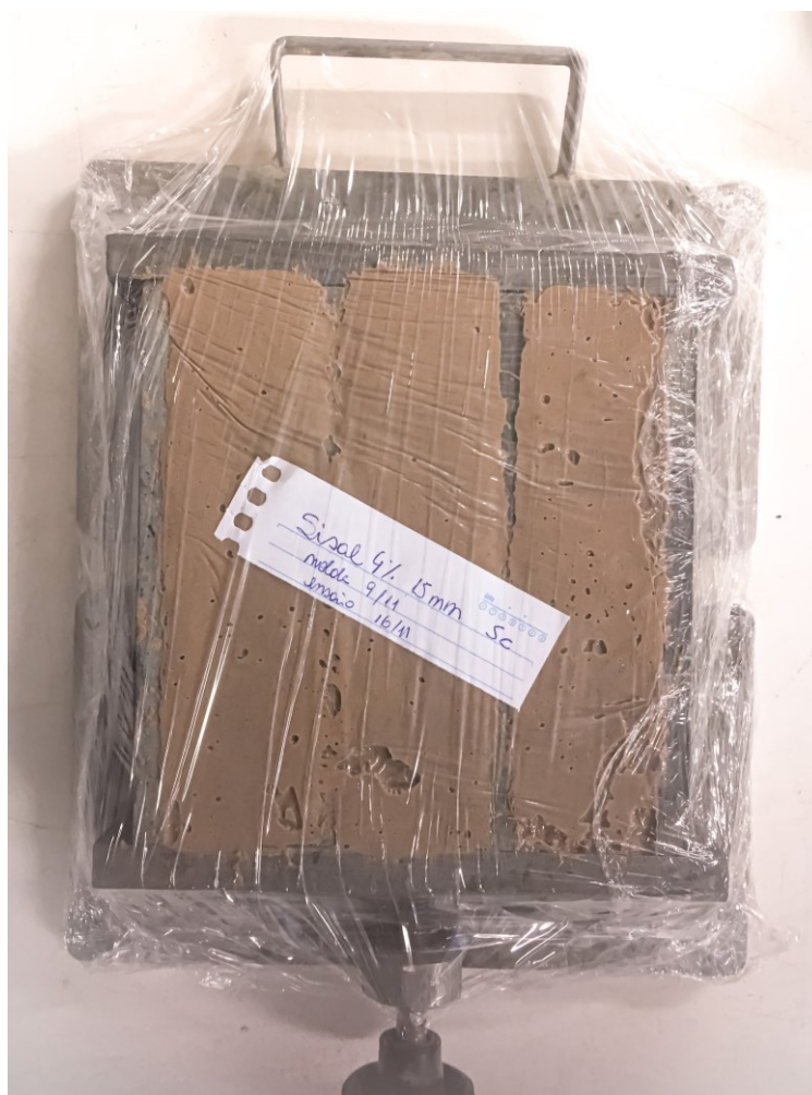
FIGURA 9: MOLDE METÁLICO CONTENDO ARGAMASSA GEOPOLIMÉRICA
