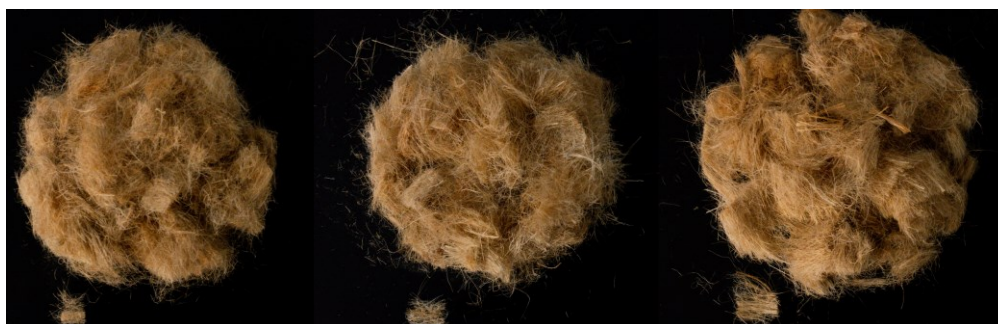
FIGURA 4: COMPRIMENTO DAS FIBRAS DE RAMI (DA ESQUERDA PARA A DIREITA: 10MM, 15MM E 20MM)
