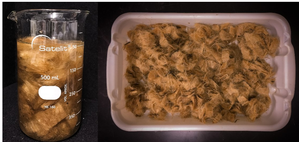
FIGURA 6: PROCESSO DE SATURAÇÃO PARA AS FIBRAS DE RAMI
