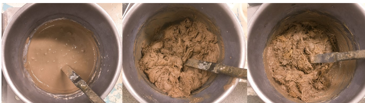
FIGURA 8: DA ESQUERDA PARA DIREITA: PASTA GEOPOLIMÉRICA; COMPÓSITO COM REFORÇO DE RAMI; COMPÓSITO COM REFORÇO DE SISAL.
