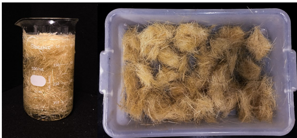
FIGURA 7: PROCESSO DE SATURAÇÃO PARA AS FIBRAS DE SISAL
