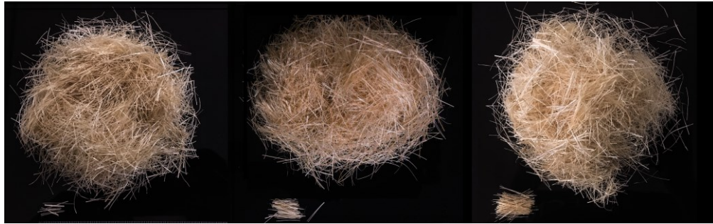
FIGURA 5: COMPRIMENTO DAS FIBRAS DE SISAL (DA ESQUERDA PARA A DIREITA: 10MM, 15MM E 20MM)
