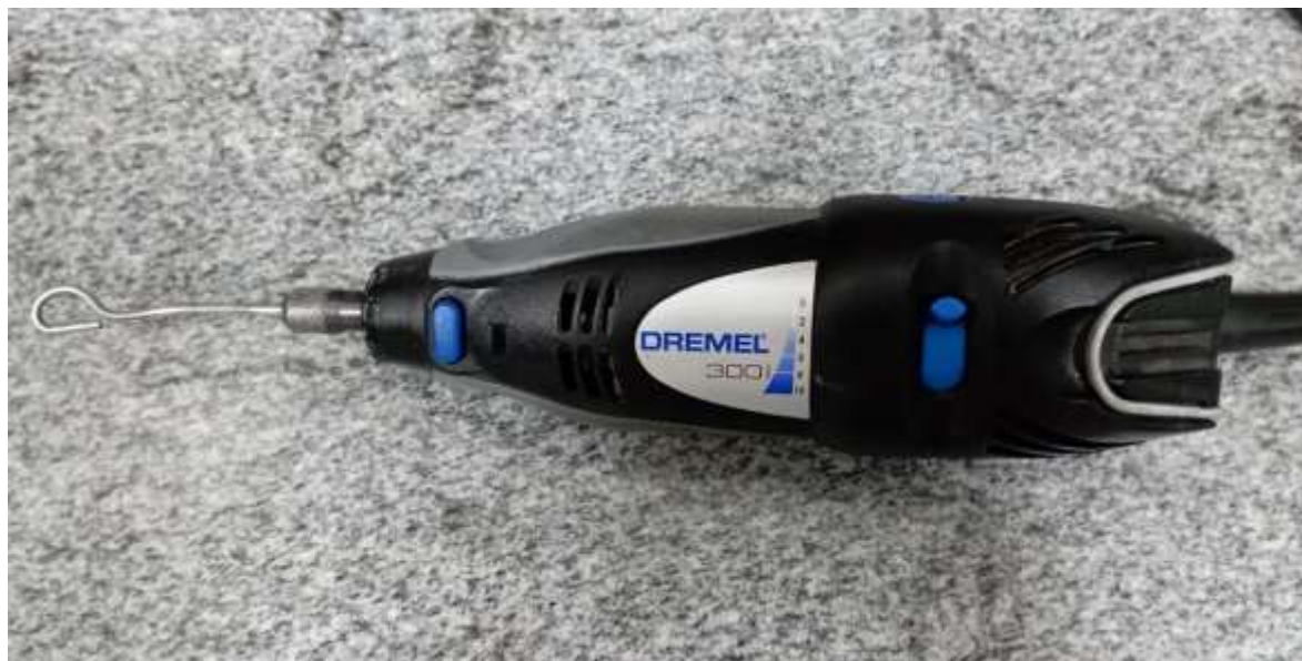
Figura 3. 4: Micro retifica Dremel 300 utilizada para homogeneização da mistura.
