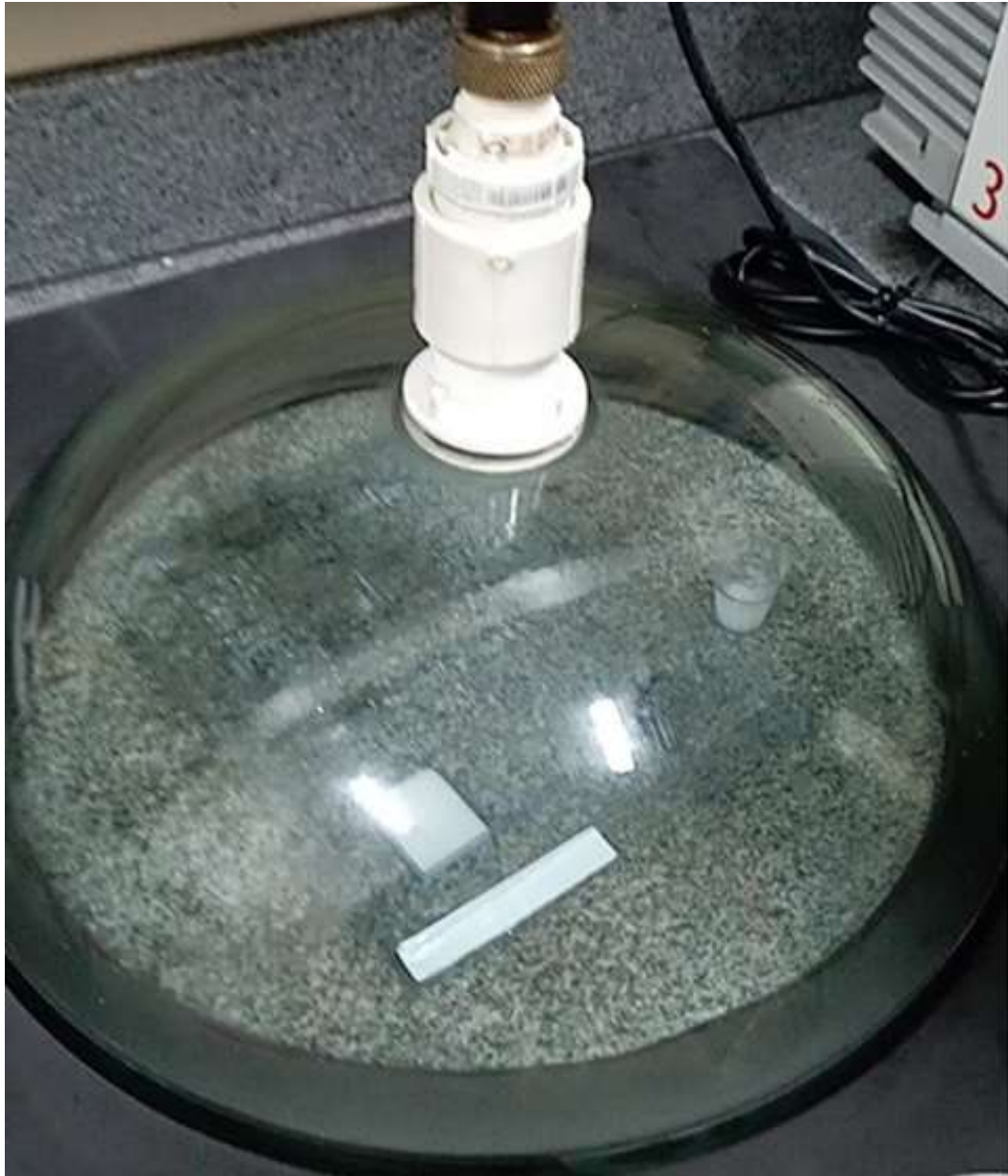
Figura 3. 1: Processo de degaseificação utilizando a bomba de vácuo para a preparação do fantoma de calibração.
