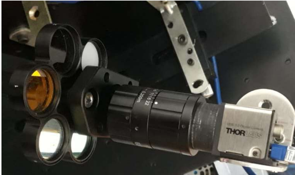
Figura 3. 10: Câmera CCD DCC3240C USB 3.0 Digital Camera acoplada à roda de filtros CFW6, ambas da Thorlabs Inc., utilizadas para a coleta das imagens.
