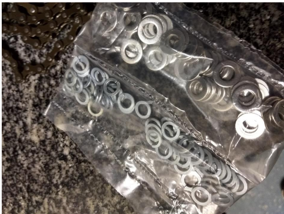
Figura 101. Arruelas de pressão e arruelas comuns para fixação dos parafusos e porcas.
