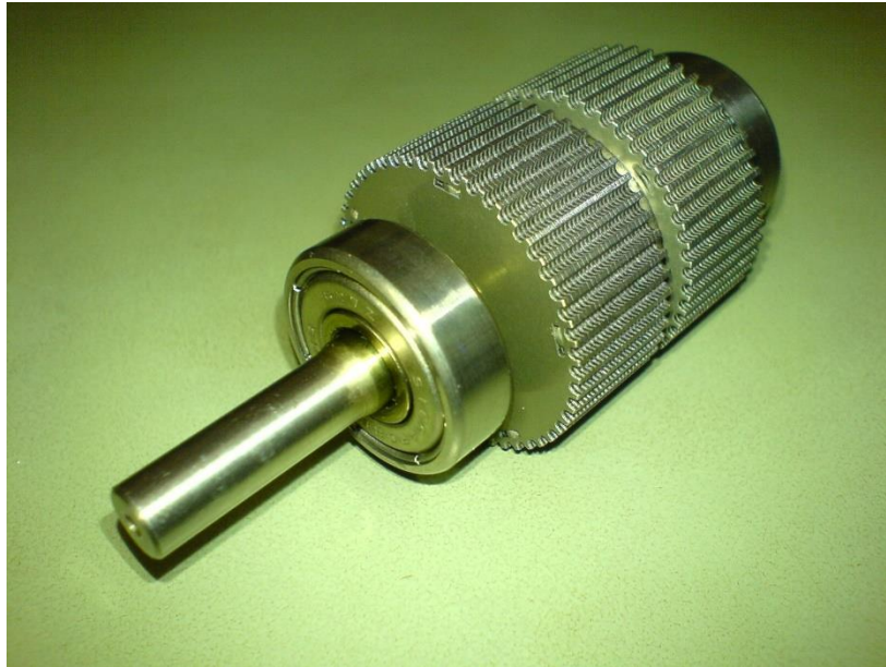
Figura 56. Rotor de motor de passo com suas saliências (< http://www.profelectro.info/tag/motor-panqueca/page/2/ >, 2019).
