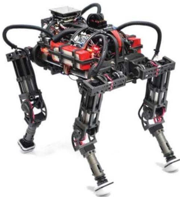
Figura 6. Robô com pernas para transporte de pequenas cargas (< https://www.researchgate.net/figure/Figura-2-Robo-AiDIN-III-cujos-atuadores-sao-pernas-articuladas-KOO-et-al-2013_fig1_320486839 >, 2019).
