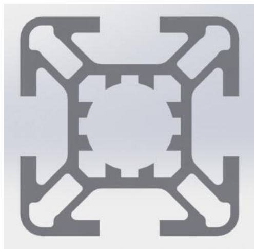
Figura 71. Desenho do perfil estrutural em corte, mostrando o formato da alma.
