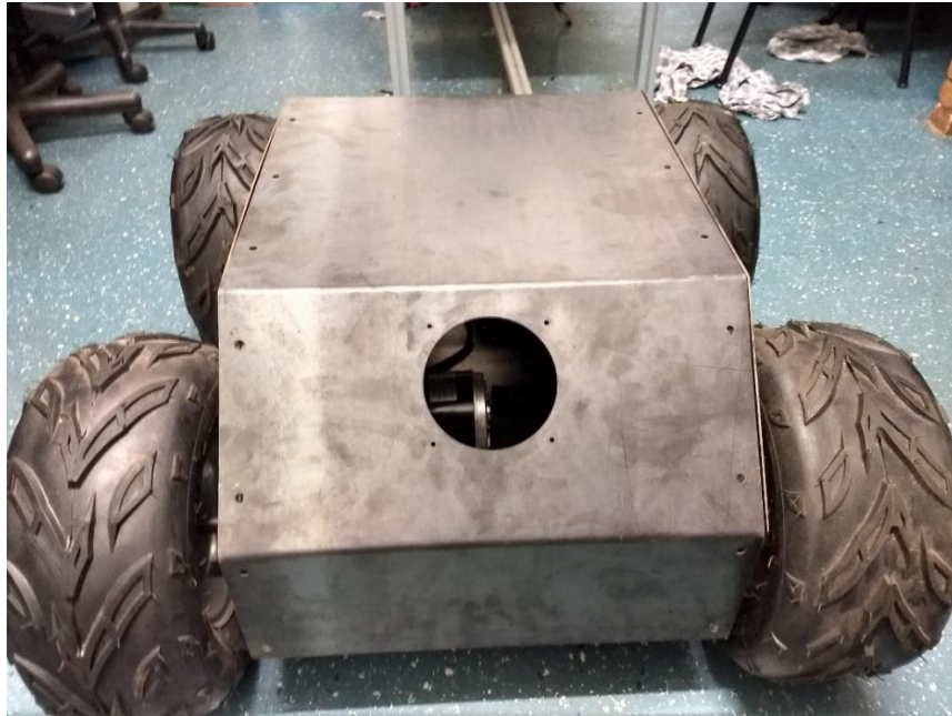
Figura 108. Montagem do robô com as chapas de fechamento.
