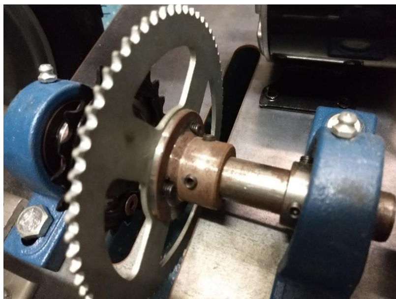
Figura 99. Acoplamento da coroa maior em destaque.
