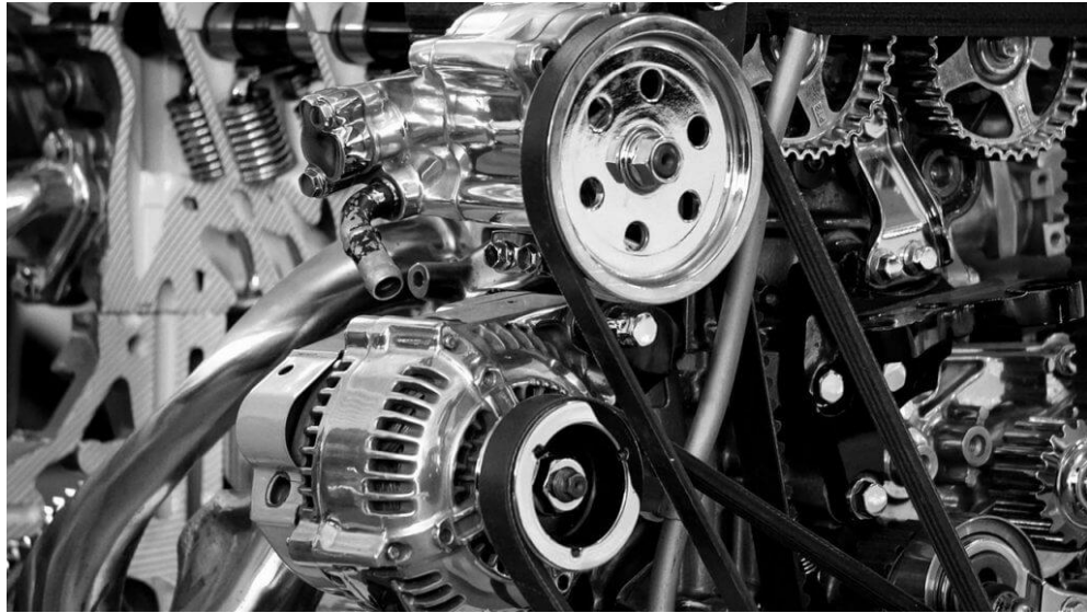
Figura 34. Jogo de polias em uso num alternador veicular (< https://www.minutoseguros.com.br/blog/correia-do-alternador/ >, 2019).
