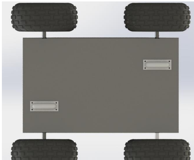
Figura 95. Renderização da vista inferior do projeto, mostrando os protetores de corrente.
