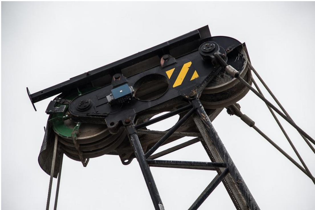
Figura 38. Polias com cabos de aço para transmissão (< https://pixabay.com/es/photos/polea-cable-gr%C3%BAa-acero-263030/ >, 2019).
