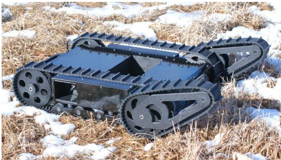
Figura 5. Robô terrestre com esteira usado na neve (< http://triangulomecatronico.blogspot.com/2012/09/como-escolher-plataforma-robotica-ideal.html >, 2019).
