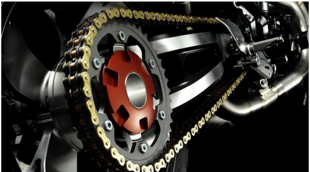
Figura 39. Corrente de rolos em transmissão de eixo traseiro de motocicleta (< https://chiptronic.com.br/blog/manutencao-da-corrente-de-moto-importancia-para-o-conjunto-de-transmissao-secundaria >, 2019).
