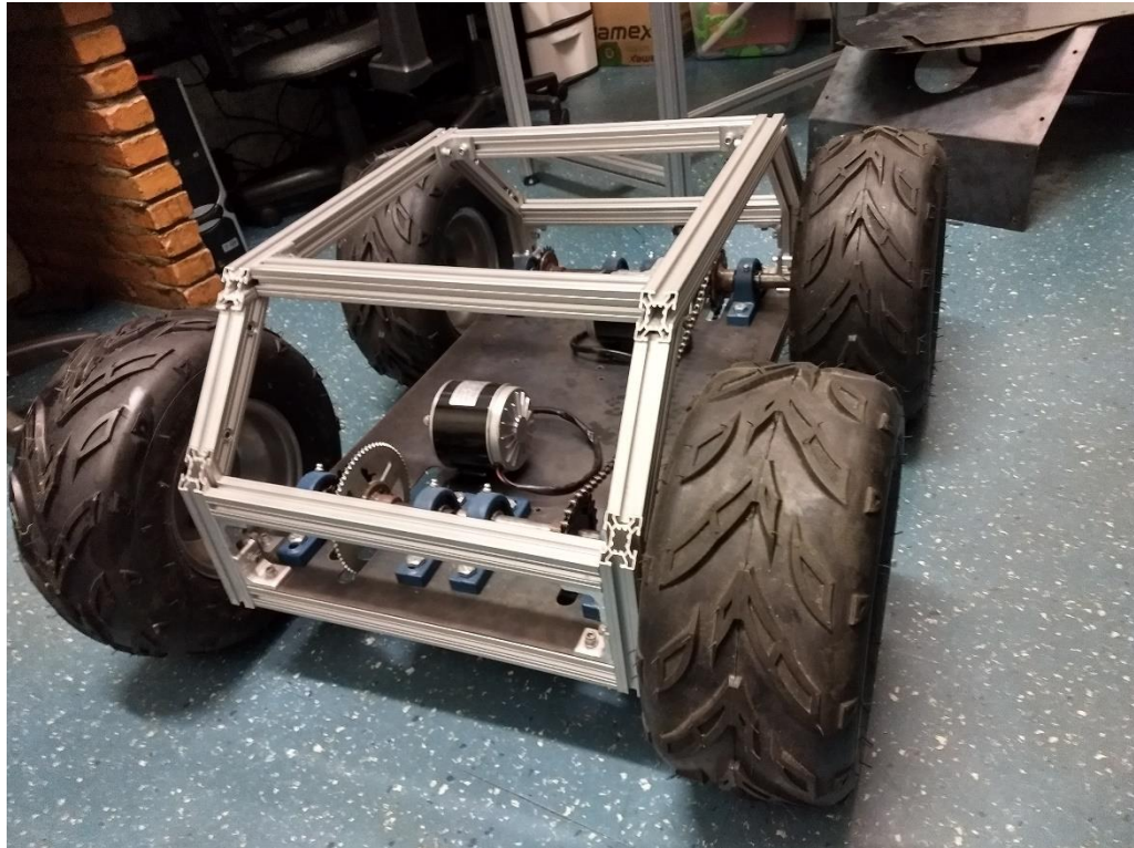
Figura 106. Montagem do robô sem as chapas de fechamento.
