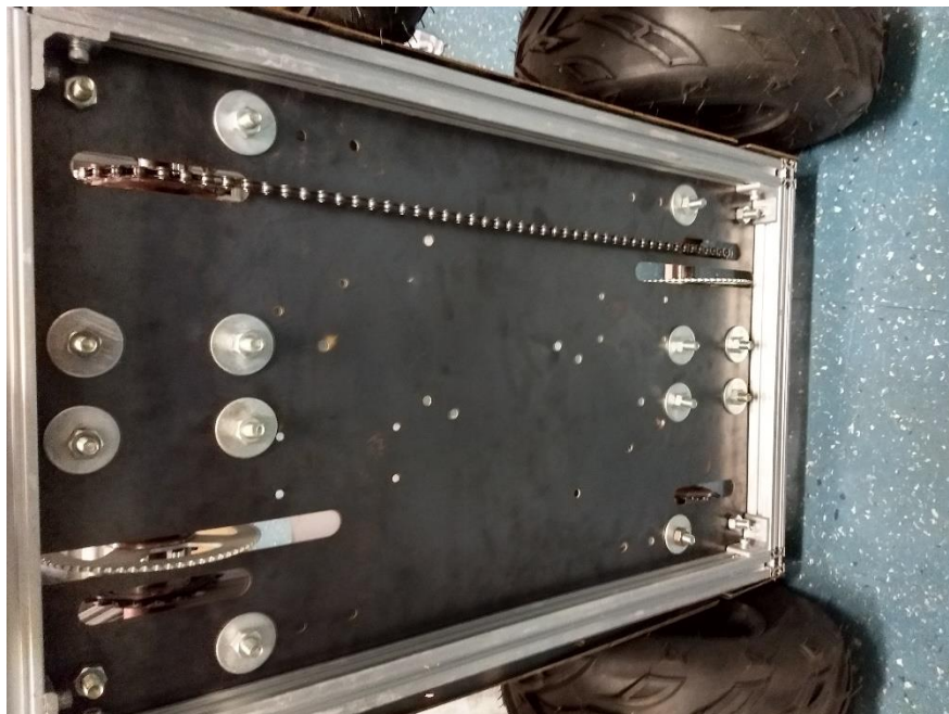
Figura 105. Montagem da corrente passando por baixo da chapa.
