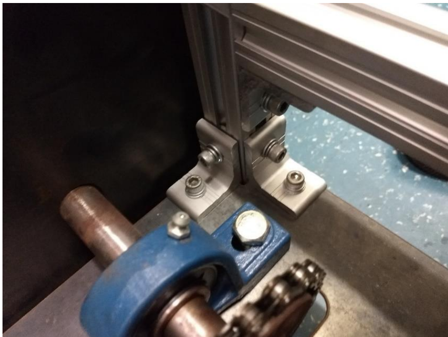
Figura 97. Montagem dos perfis com cantoneiras.
