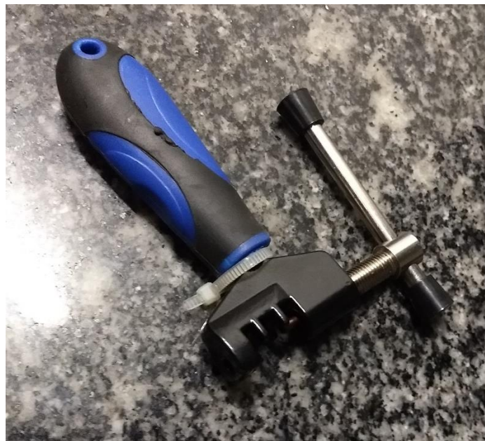
Figura 103. Chave extratora saca pino usada para montar a corrente.
