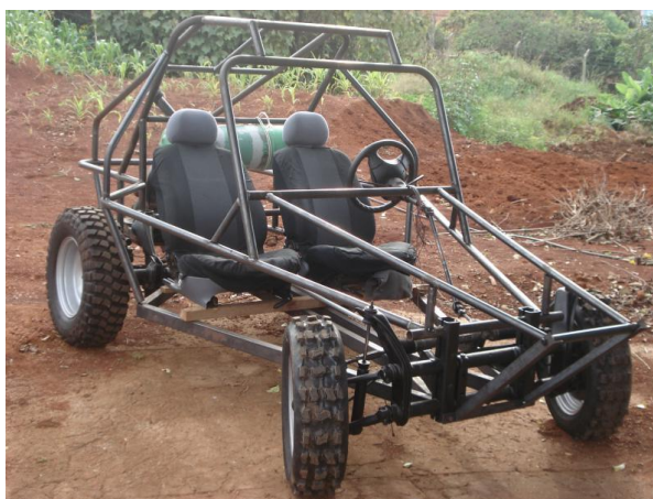
Figura 7. Modelo de estrutura do tipo gaiola usada em ambientes externos (< https://www.4x4brasil.com.br/forum/gaiola-baja-e-buggy/91323-novo-projeto-gaiola-tubular-traseira-de-kombi.html >, 2019).
