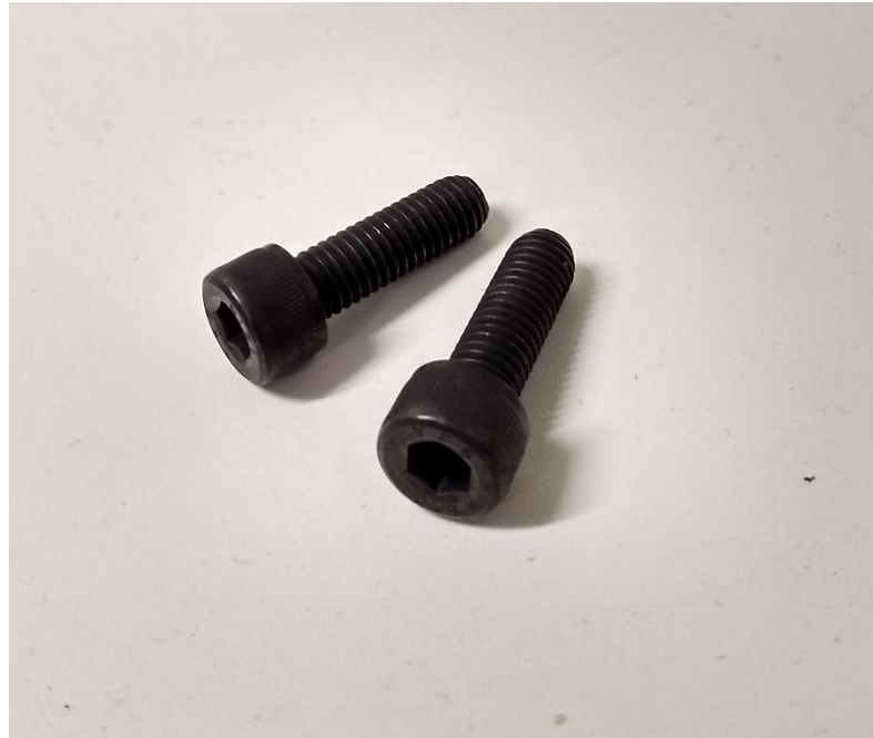
Figura 102. Parafusos M6 allen usados para fixar os suportes de ABS impressos na chapa de fixação.
