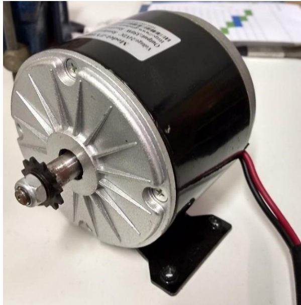
Figura 96. Motor brushed (com escovas) de corrente contínua para a tração do robô.
