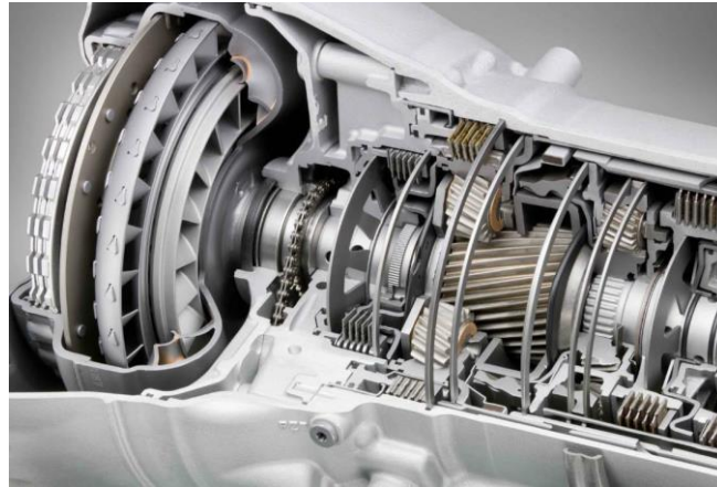
Figura 27. Câmbio automático veicular com seu conjunto de planetárias (< https://autovideos.com.br/como-funciona-cambio-automatico/ >, 2019).
