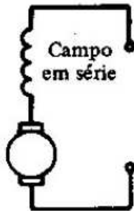
Figura 51. Esquema elétrico simplificado de motor com excitação série (< https://pt.slideshare.net/tiagosantiago125/microsoft-power-point-motores-e-geradores-cc-20112a?from_action=save >, 2019).
