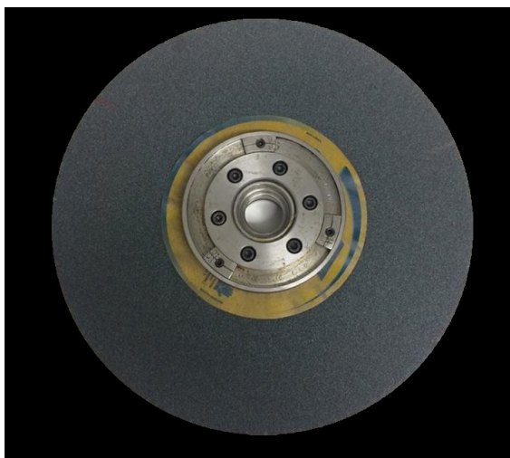
Figura 3.2 - Rebolo de SiC 39C60KVK com flange de fixação e contrapesos de balanceamento utilizado nos ensaios.
