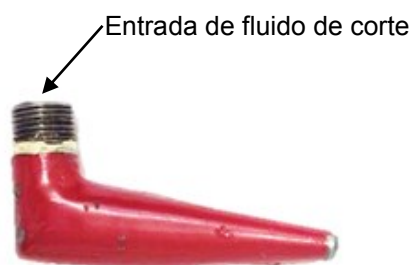
a) Bocal utilizado nos ensaios com a técnica de aplicação de fluido de corte convencional.
