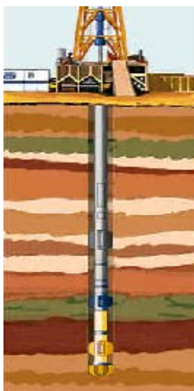
Figura 1.1: Esquema da perfuração vertical de poços de petróleo.
