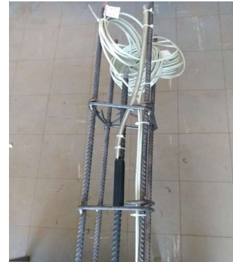
c) Barra instrumentada fixada na armação da estaca
