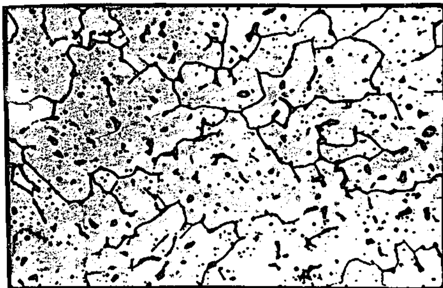
Figura 4.8- Amostra 6: E 725 W (500 X) - HV_{20} = 294 - Ataque: FeCl_3 + HCl - Caracterização: Finas partículas de carbonetos e poças de ferrita irregulares na matriz austenítica.
