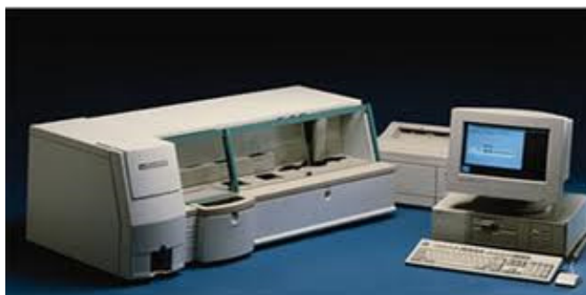
Figura 3. Sistema de caracterização microbiana - RiboPrinter® .
