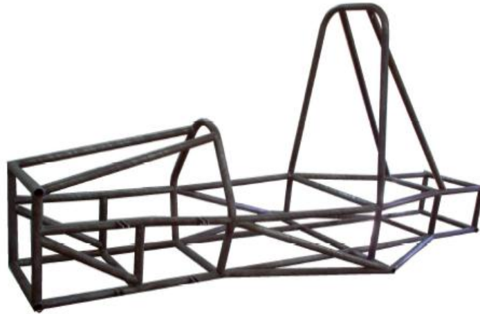
Figura 1.1 – Estrutura do tipo spaceframe de um Formula SAE desenvolvida por Baker (2004).
