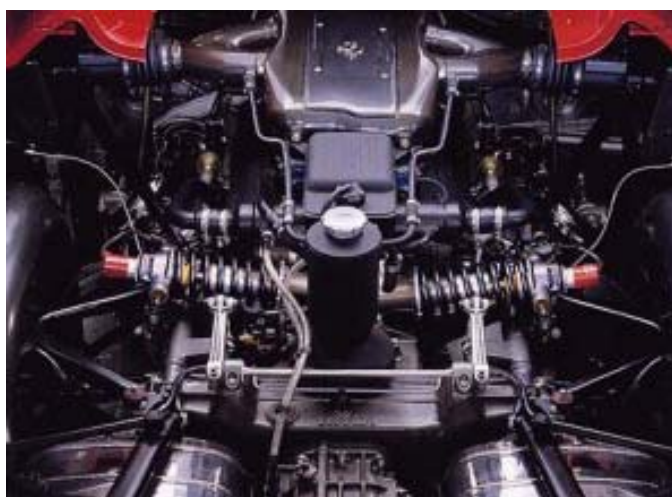
Figura 2.4 – Suspensão traseira de um veículo de competição unida diretamente ao conjunto motor-transmissão. (Retirada de AutoZine Technical School Web Site, 2006).
