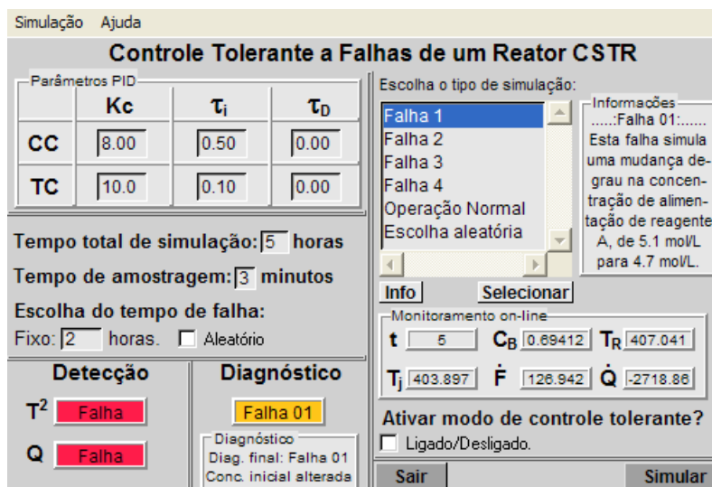
Figura 4.28: Interface gráfica do simulador desenvolvido em linguagem Tcl/Tk para o processo de produção de ciclopentanol.
