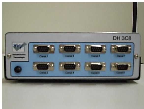
Figura 5.28 Foto do painel frontal do condicionador.
