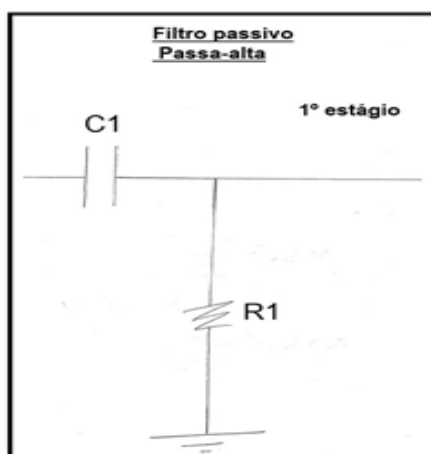
Figura 15 - Representação de um filtro passivo passa alta genérico
