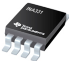
Figura 11 - Amplificador operacional de instrumentação INA331
