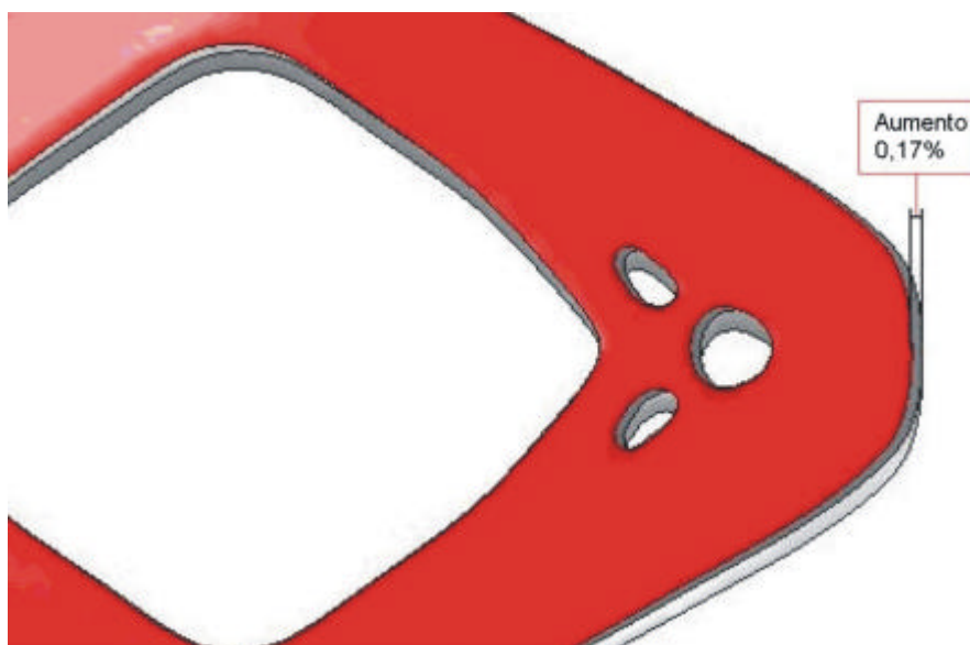
Figura 6. 10 – Aumento no comprimento do stent 1 após a recuperação elástica.
