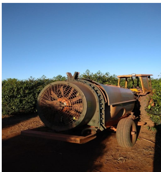
Figura 1. Pulverizador hidropneumático modelo Arbus 2.000 VM.
