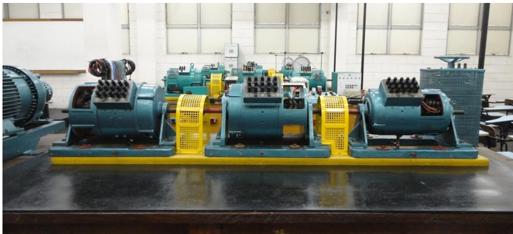
Figura 6.3 Conjunto Moto Gerador
