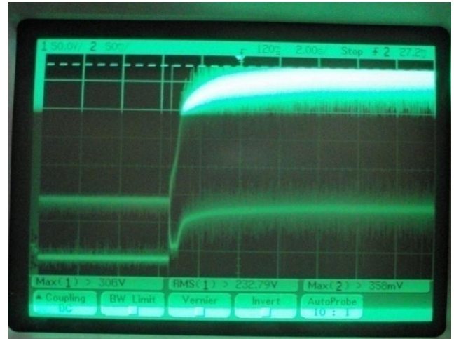
Figura 6.28 Tensão e corrente de campo do gerador conectada com carga indutiva em paralela a MIT de 2,0 CV.
