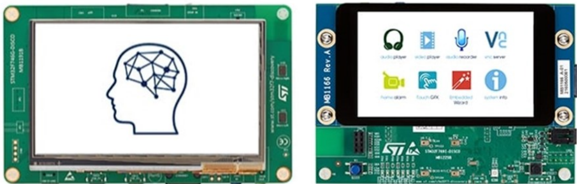
Figura 15 : STM32F746G-DISCO (Esquerda) e STM32F769I-DISCO (Direita)
