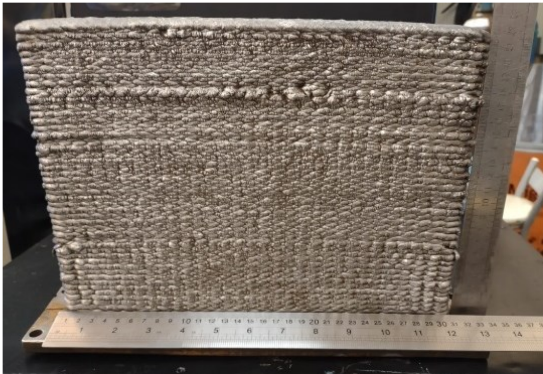
Figura 3.2 - Parede RAQI com 94 camadas depositadas. Fonte: autor (2025)
