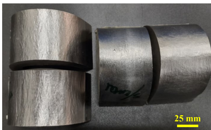
Figura 4.4 - Corpos de prova do ensaio de dobramento da parede sem resfriamento, segundo norma AWS D1.1, à esquerda os corpos horizontais e à direita, os corpos horizontais. Fonte: autor (2025)
