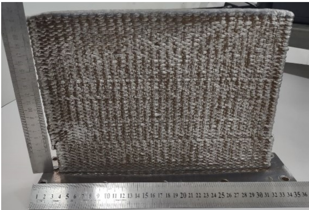
Figura 3.3 - Parede sem resfriamento com 95 camadas depositadas. Fonte: autor (2025)
