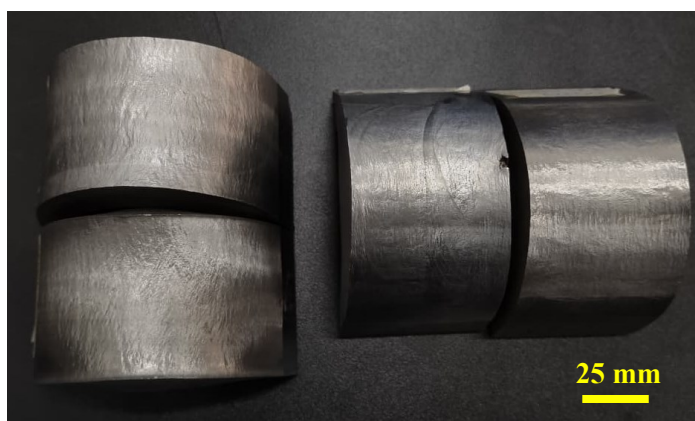
Figura 4.3 - Corpos de prova do ensaio de dobramento da parede com RAQI, segundo norma AWS D1.1, à esquerda os corpos horizontais e à direita, os corpos horizontais. Fonte: autor (2025).
