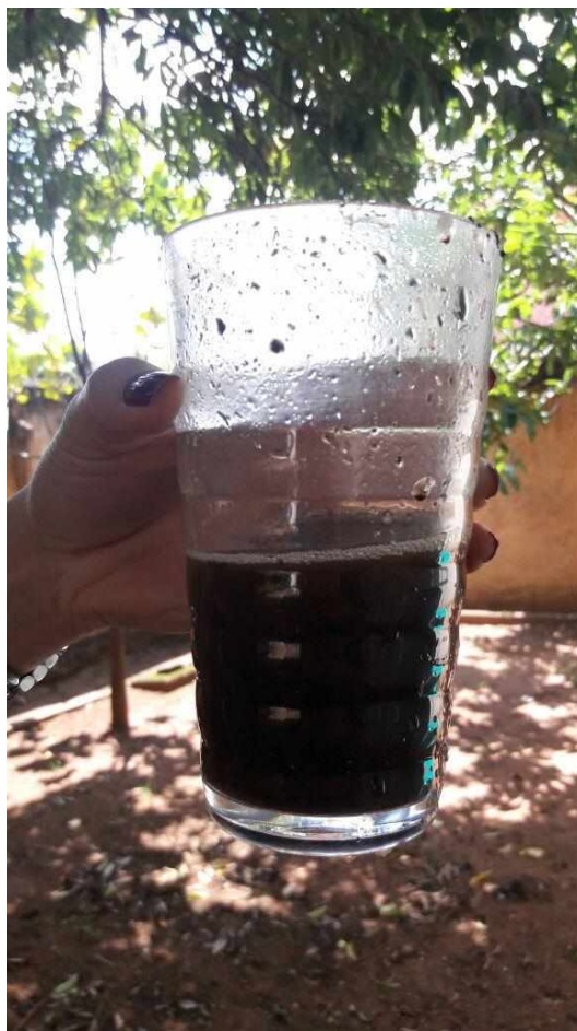
Figura 15 Teste de maturidade do composto
