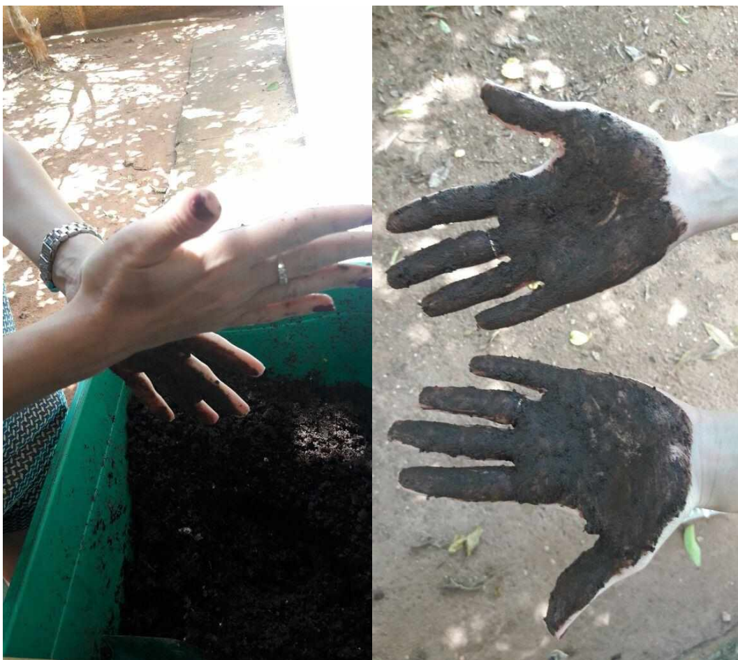
Figura 16 Teste de Mão para determinar maturação de Composto
