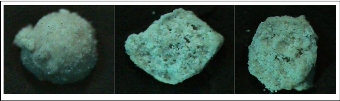
Figura C.13 – Fotos feitas com lupa, de grânulos com características típicas do Exp 25.
