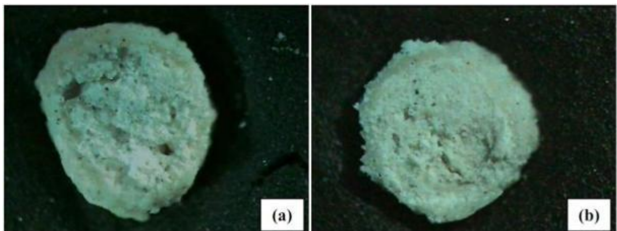
Figura 4.7 – Alto tempo e alto enchimento Exp13 e Exp 14 (a) baixa rotação (b) alta rotação: ambos apresentam anel externo, porém, a alta rotação gerou grânulos com menos poros e melhor cimentação.
