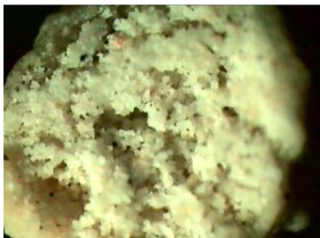
Figura 4.32 – Foto tirada com lupa de seção interna típica de grânulos do Experimento 05: observa-se grande aglomeração de partículas pequenas.
