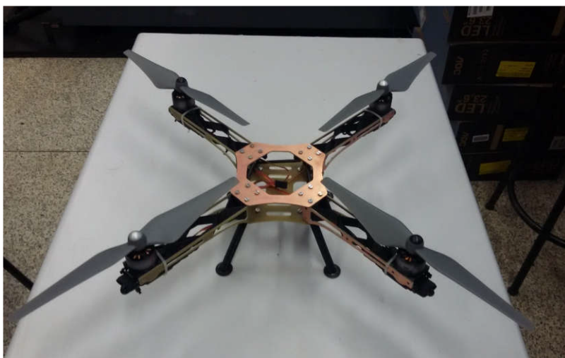
Figura 30 – Estrutura desenvolvida na impressora 3D
