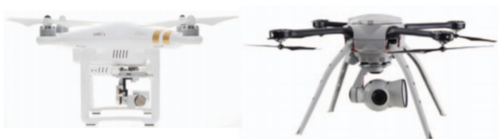
Figura 11 – Multicópteros na configuração pull (a) e push (b), da esquerda para a direita.
