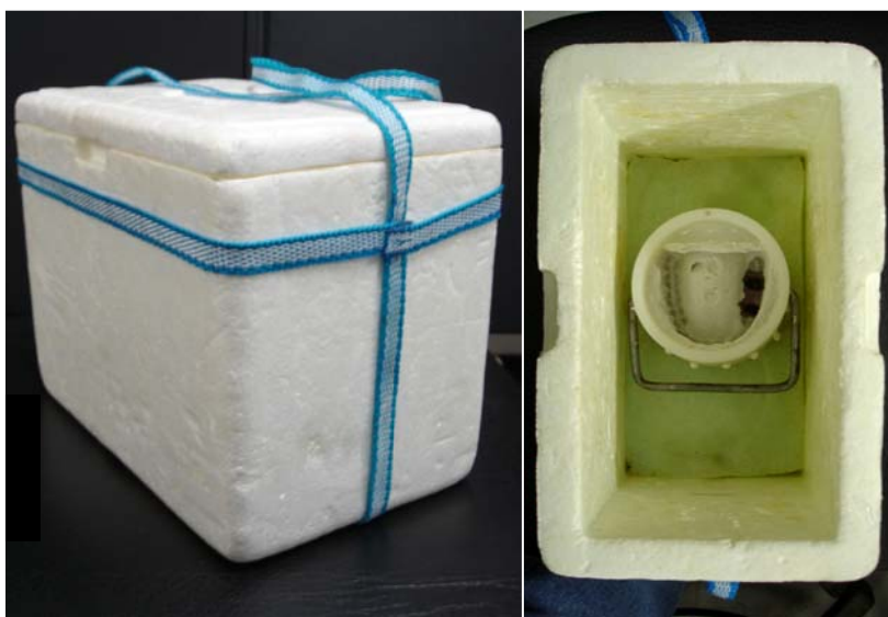
Figura 11. Armazenagem do molde em caixa térmica, mantendo temperatura e umidade constantes.
