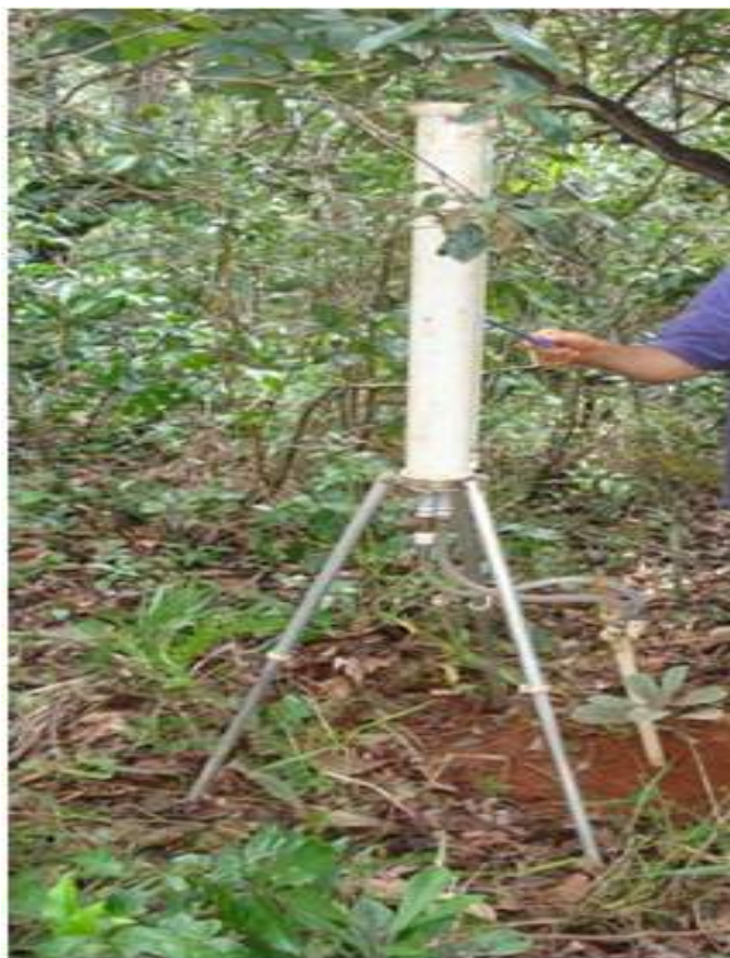
Figura 37. Permeâmetro Guelph. Ensaio de solo na bacia do Alto Uberabinha.
