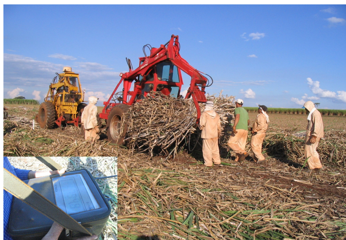
FIGURA 06. Pesagem dos colmos da cana (detalhe: célula-de-carga).
