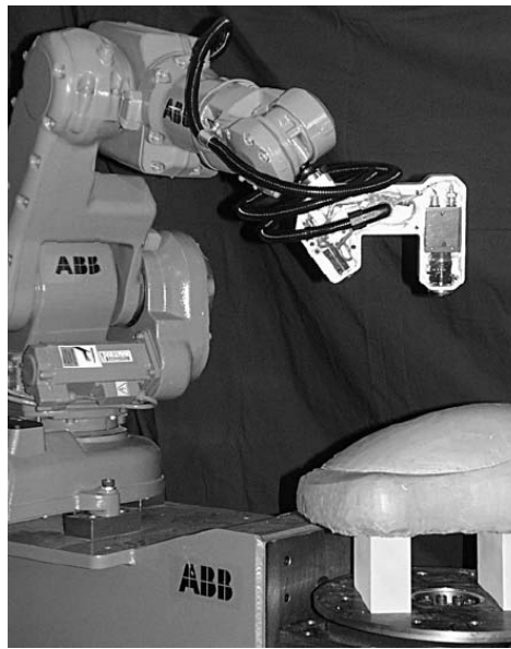
Figura 2.6 - Digitalizador tridimensional robótico (LARSSON; KJELLANDER, 2006)
