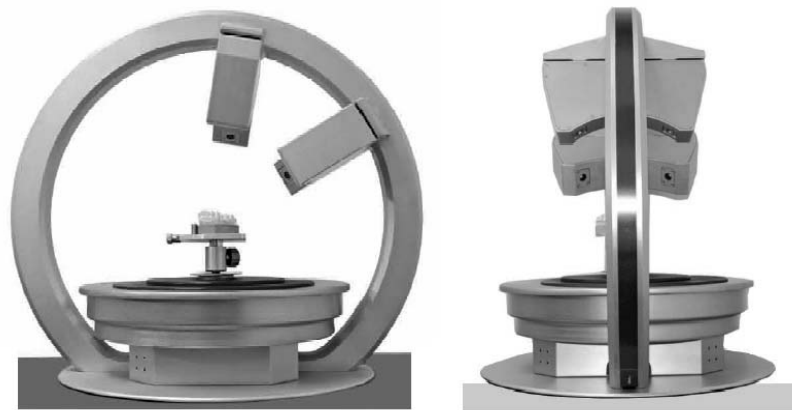
Figura 2.11 - Digitalizador tridimensional comercial para peças dentárias-i3Evolution
