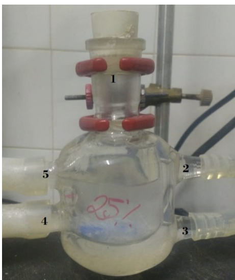
Figura 3.2 - Foto da célula de equilíbrio 1 - 1.Entrada de água; 2.Saída de água; 3,4.Pontos de amostragem; 5.Ponto de inserção da rolha e fixação do termopar.
