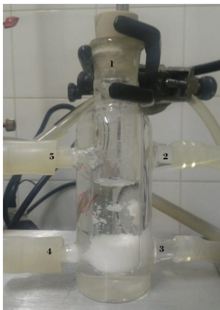
Figura 3.3 - Foto da célula de equilíbrio 2 - 1.Entrada de água; 2.Saída de água; 3,4.Pontos de amostragem; 5.Ponto de inserção da rolha e fixação do termopar.
