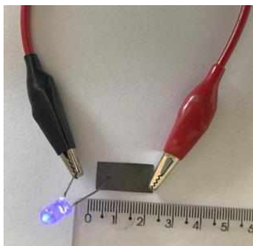
Figura 15. Teste de condutividade com uma lâmpada LED conectada a uma bateria.
