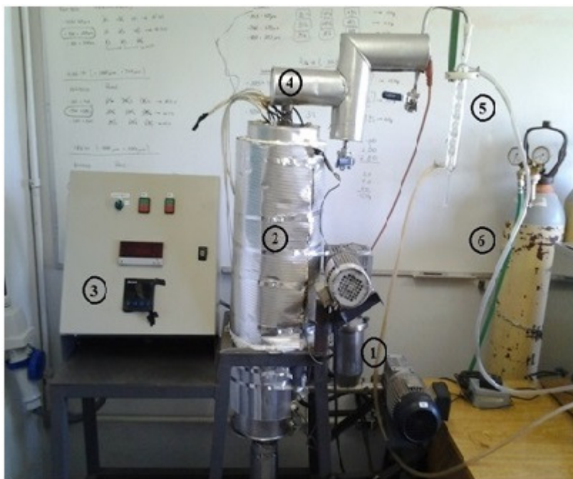
Figura 2.6 – Esquema da unidade experimental: (1) Alimentador; (2) Reator de leito fluidizado; (3) Painel de instrumentação; (4) Ciclones; (5) Condensador; (6) Cilindro de Nitrogênio.
