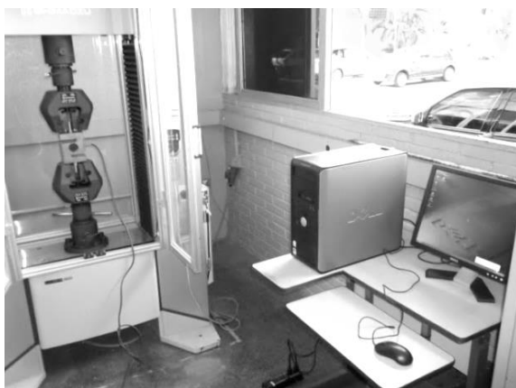
Figura 3.23 – Sistema de calibração da célula de carga: máquina de ensaio de tração e o sistema de captura de dados do LAPROSOLDA/UFU
