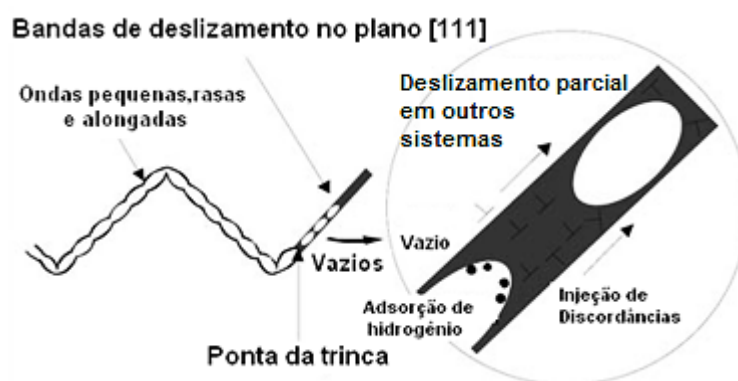
Figura 2.6 – Diagrama ilustrando o processo de adsorção induzida por deslizamento localizado que ocorrem ao longo de planos de corte alternativo (LYNCH, 1996).
