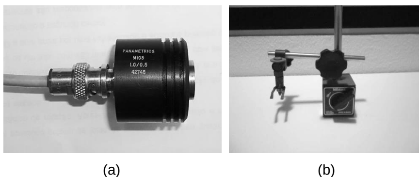
Figura 3.13 – (a) Sensor utilizado nos ensaios Implante e Tekken; (b) Dispositivo para fixação do sensor na chapa teste (base magnética)
