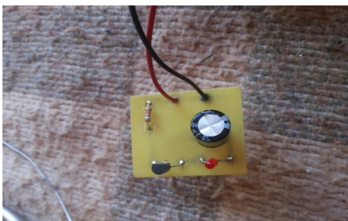
Figura 28: Vista superficial dos componentes soldados na placa ou substrato.
