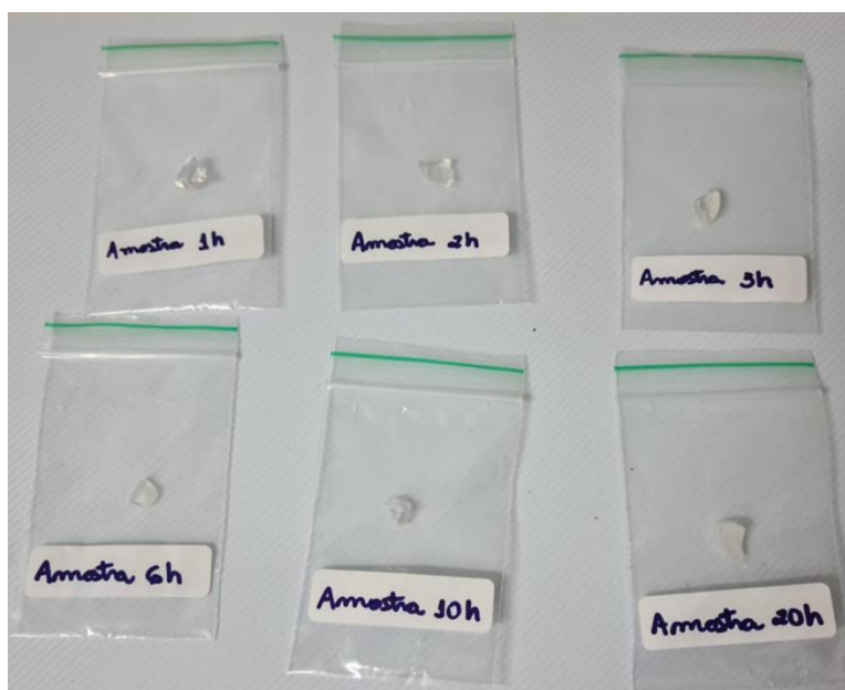
Figura 8 – Amostras experimentais utilizadas NCAL em diferentes tempos de tratamento térmico
