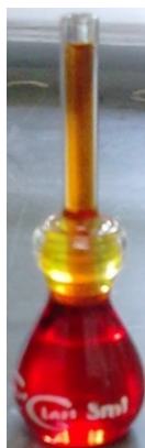
Figura 20 – Picnômetro contendo ésteres, a fim de determinar a densidade relativa.
