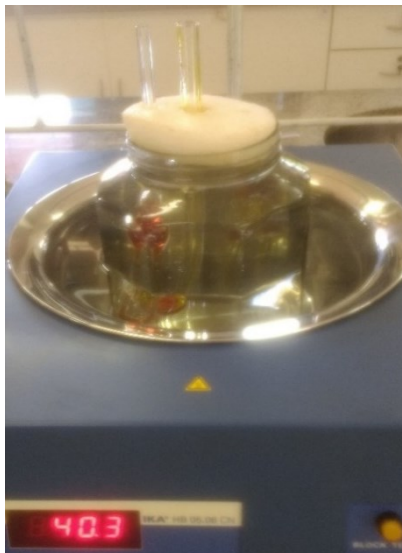
Figura 21 – Viscosímetro contendo ésteres, a fim de determinar a viscosidade cinemática.
