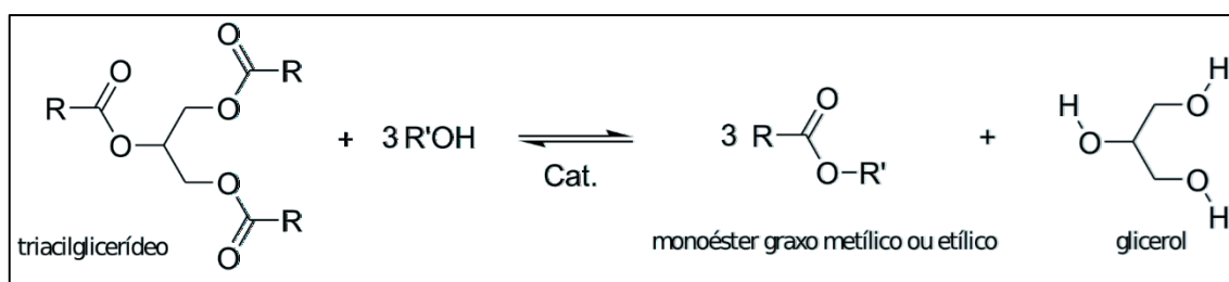
Figura 9 – Reação geral da transesterificação de um triglicerídeo para a obtenção para a obtenção de monoésteres.
