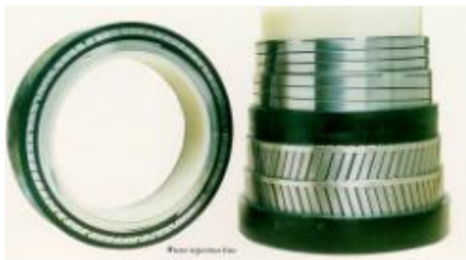
Figura 1.2 - Trechos de dutos flexíveis utilizados na exploração de petróleo e gás na Bacia de Campos, mostrando as diferentes camadas.
