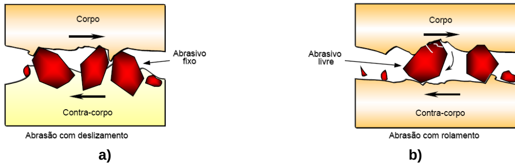
Figura 2.5 – Configuração mecânica do processo de desgaste abrasivo por: a) Deslizamento e b) Rolamento (RAMOS NETO, 2003).
