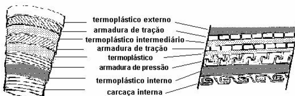
Figura 2.8 – Estrutura típica de um duto flexível (Souza et al. ,2000).
