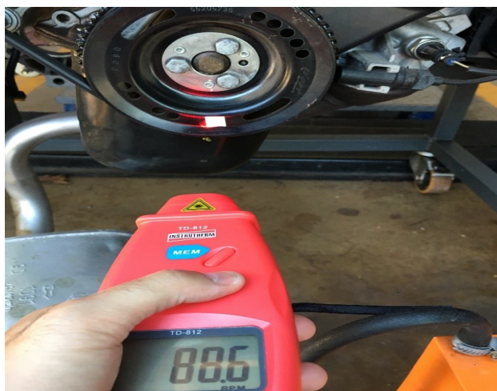
Figura 3.7 – Posicionamento do tacômetro para coletas de dados Fonte: AUTOR PRÓPRIO.
