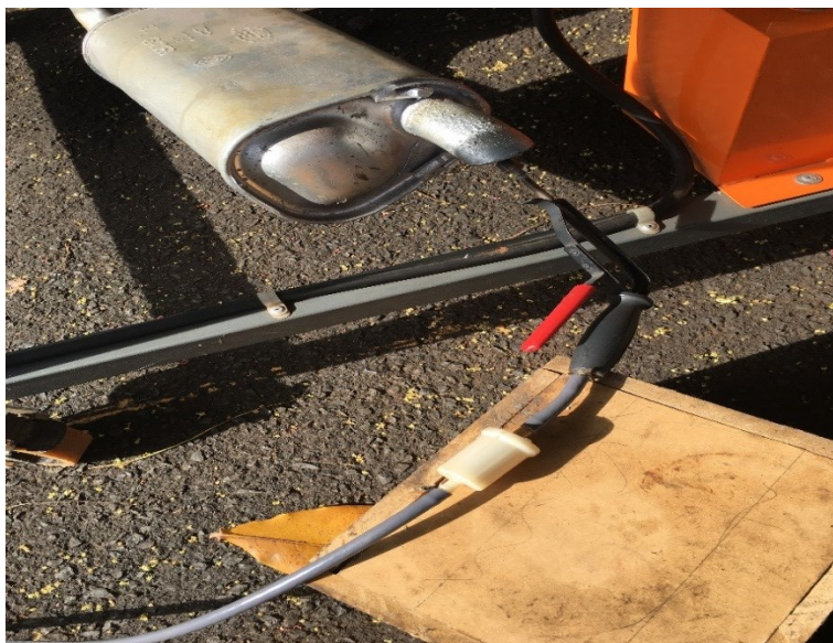
Figura 3.8 – Posicionamento da manopla contendo a sonda coletora de gases Fonte: AUTOR PRÓPRIO.
