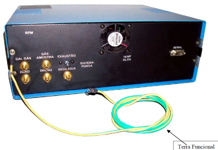
Figura 3.4 – Vista traseira do analisador de gás Fonte: NAPRO (2013)
