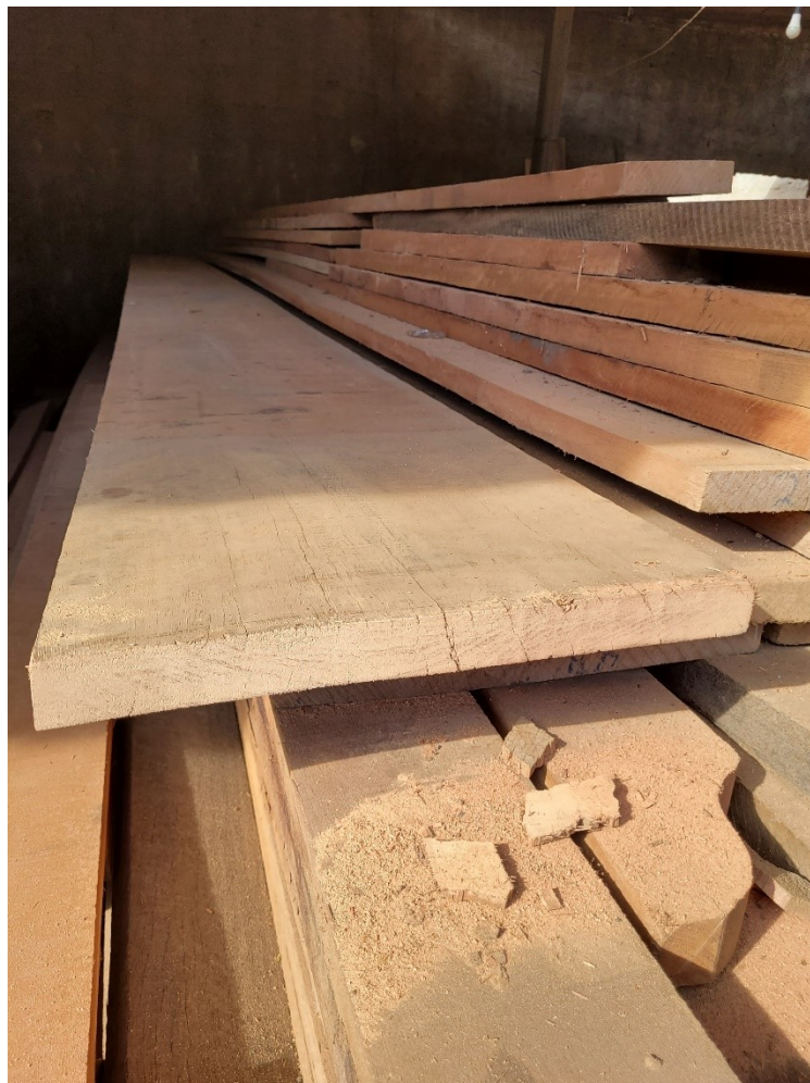
Figura 17 – Prancha após o corte com serra tico-tico.
