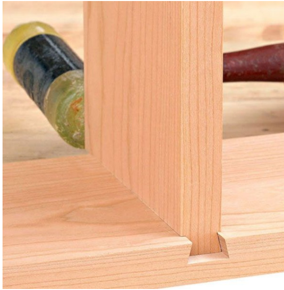
Figura 7 – Exemplo de encaixe ganzepe
