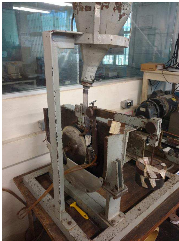
Figura 3.4 – Foto do tribômetro roda de borracha atual. (PRÓPRIO AUTOR)
