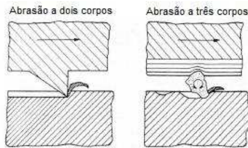
Figura 2.9 – Desgaste abrasivo a dois e três corpos (ZUM GAHR, 1987)
