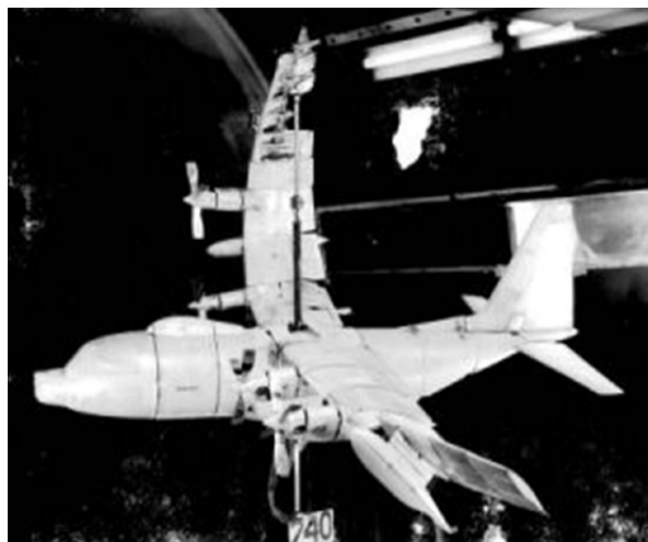
Figura 2.6: Modelo em escala submetido à condição de flutter em ensaio de túnel de vento, Campregher (2005)
