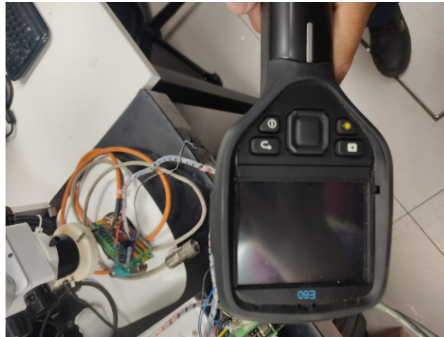
Figura 19. Medidor de temperatura utilizado nos diagnósticos.
