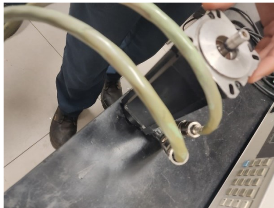
Figura 31. motor CC utilizado na avaliação via giga de teste.
