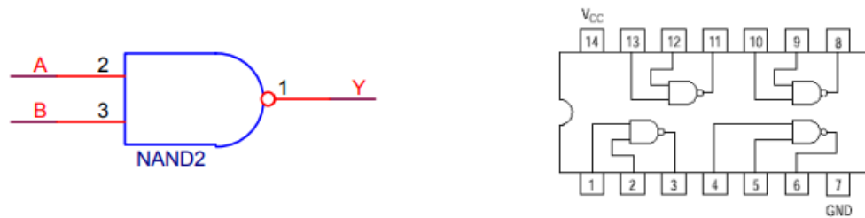
Figura 4. Circuito Integrado Operação Lógica NAND (Pontifícia Universidade Católica do Rio Grande do Sul, s. d.).
