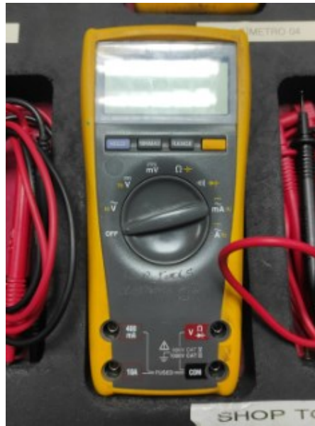
Figura 21. Multímetro utilizado nas identificações de falhas no circuito.
