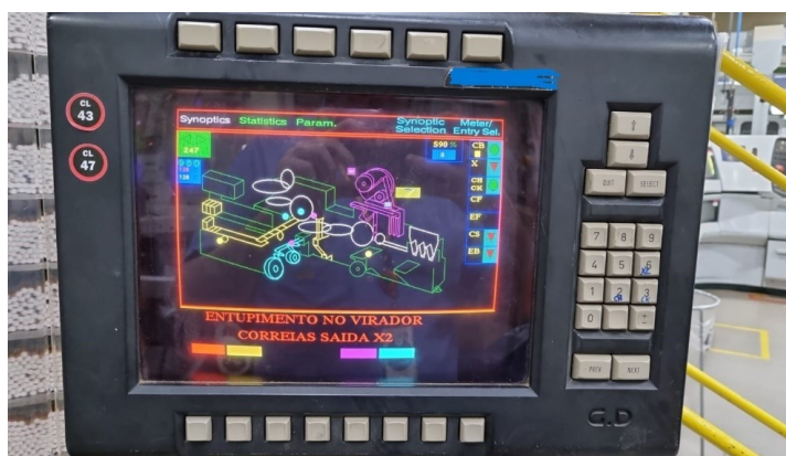
Figura 26. Falha apresentada durante acompanhamento a produção.
