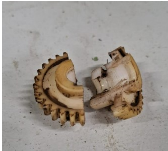
Figura 8. Exemplo de peça quebrada gerando falha na máquina.
