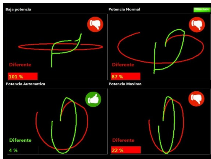
Figura 23. Identificador de defeitos operando (Rastre Curve, 2019).
