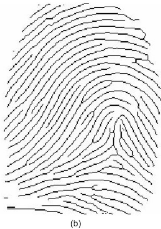
Figura 4.11 – Exemplo de correção das falhas nas saliências. (a) imagem binarizada de uma impressão digital. (b) imagem resultante após a correção das falhas na imagem da letra (a).
