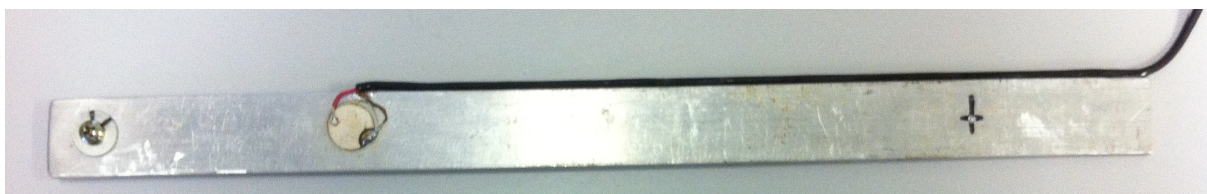
Figura 4.9 – Viga com dano inserido à distância de 20 cm da pastilha de PZT.
