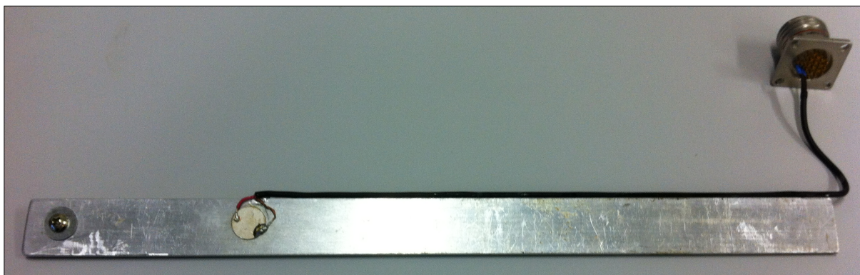
Figura 4.1 - Montagem experimental de viga de alumínio parafusada.
