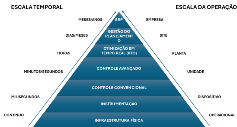
Figura 1 – Hierarquia Funcional e Temporal dos Sistemas de Controle em Plantas Industriais.
