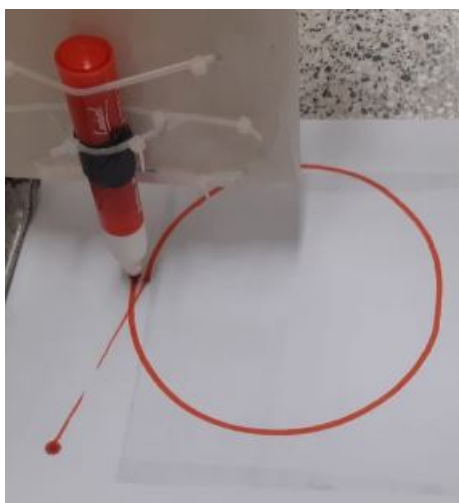
Figura 73 – Resultado desenho da circunferência utilizando o robô cartesiano modificado
