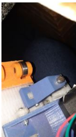
Figura 38 – Montagem da peça do motor do carro Z sem modificação
