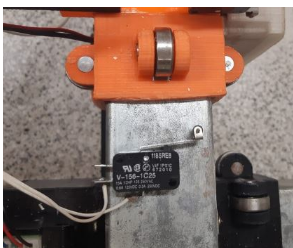
Figura 62 – Instalação fim de curso eixo X
