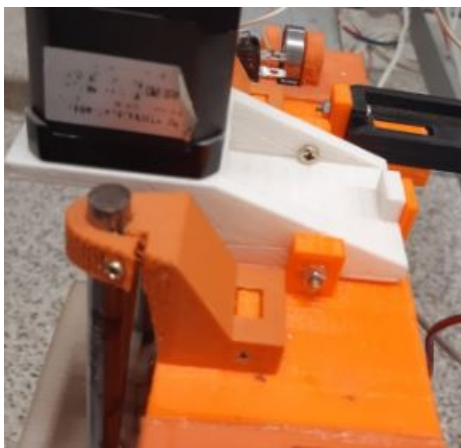
Figura 43 – Montagem da peça do eixo do carro Z com modificação
