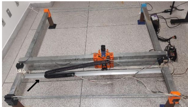
Figura 46 – Estrutura CNC com a barra suporte de cabo alterada
