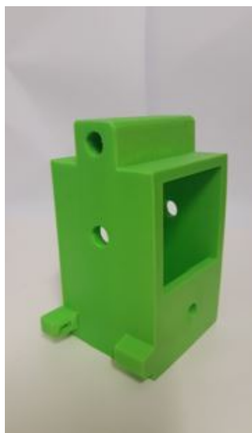
Figura 44 – Peça com sentido de impressão modificado
