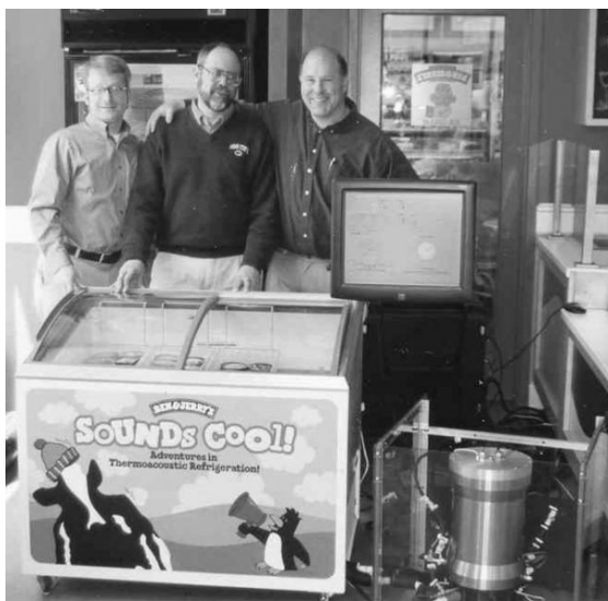
Figura 1.4 – Imagem do refrigerado, TADTAR (Thermoacoustic Driven Thermoacoustic Refrigerator), com os seus pesquisadores.
