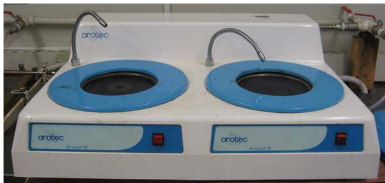
Figura 3.6: Equipamento utilizado no Lixamento de marca aropol S da marca arotec.
