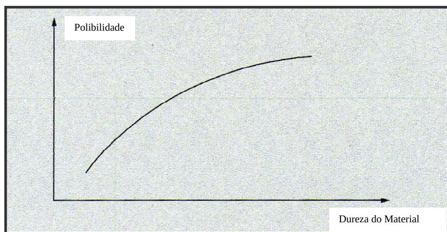
Figura 2.17 – Relação da dureza do aço com a polibilidade (Bengtsson, 1983).
