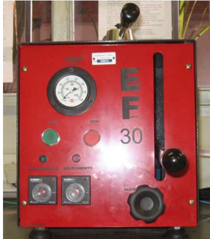
Figura 3.5 – Equipamento utilizado para o embutimento das amostras.
