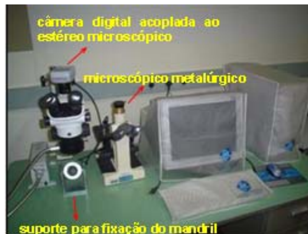
Figura – 3.17. Sistema de aquisição de imagens (45X).
