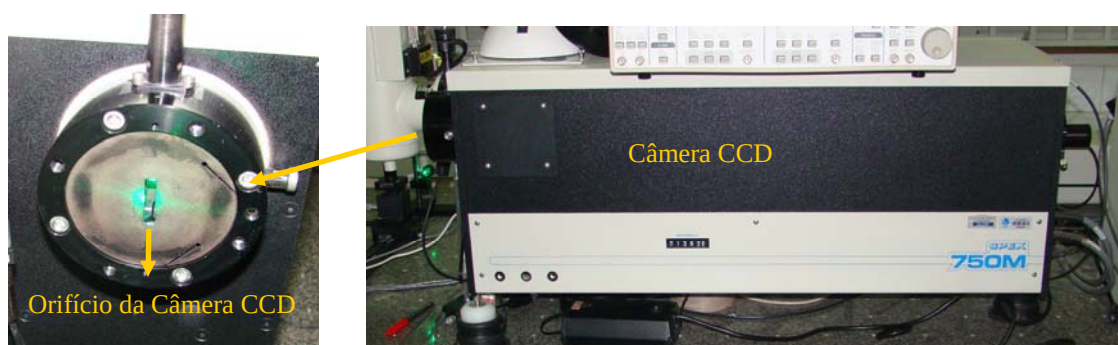
Figura 3.12 – Câmera CCD utilizada nos experimentos de refletividade.
