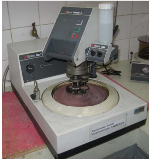
Figura 3.7: Equipamento utilizado no polimento de marca labopol-2 da marca Struers.
