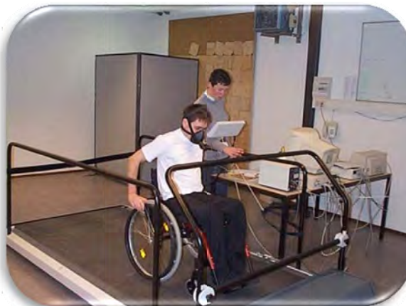
Figura 2.22 – Esteira utilizada para testes físicos de cadeirantes e validação de cadeira de rodas. Fonte: van der Woude; de Groot; Janssen, (2006)
