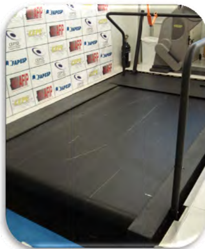
Figura 2.20 – Ergômetro de esteira para cadeira de rodas. Fonte: Centro de Estudo de Fisiologia do Exercício (CEFE) da Universidade Federal de São Paulo (Unifesp)
