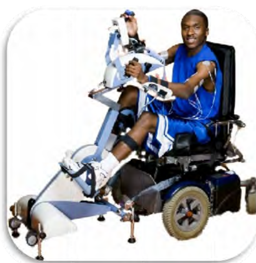
Figura 2.15 – Cicloergômetro de braços e pernas com estimulação elétrica RT300-SLSA.
