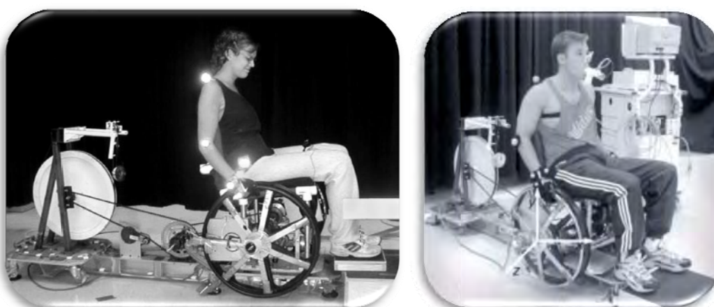
Figura 2.25 – Ergômetro de cadeira de rodas e sistema de análise de movimento tridimensional. Fonte: (a) Finley et al. (2002); (b) Finley et al. (2004)
