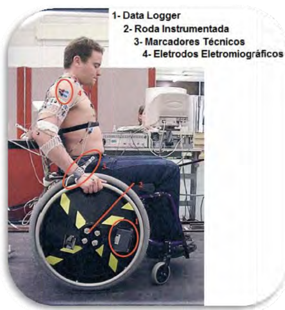
Figura 2.21 – Cadeira de rodas instrumentada para teste em esteira. Fonte: Adaptada de van Drongelen et al. (2005)
