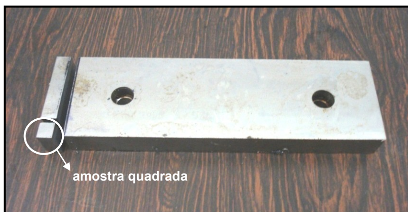
Figura 3.4. Detalhe da retirada da amostra na peça, escolha das seções para análise metalográfica.
