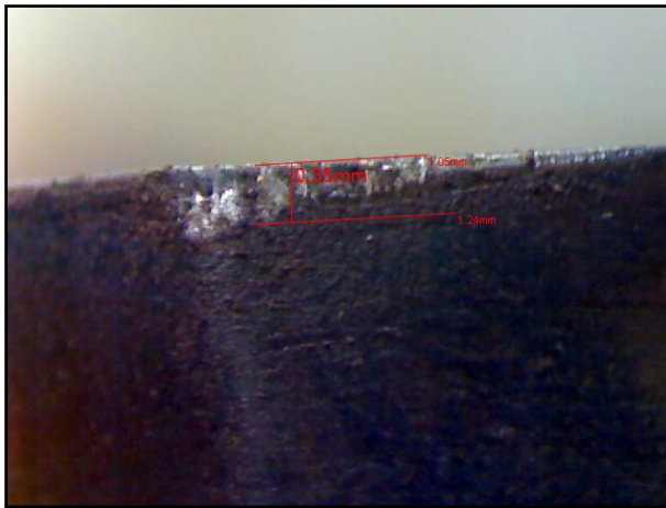
Figura 4.34. Desgaste médio de flanco. Algodão, vc = 450 m/min, fz = 0,20 mm/rev.
