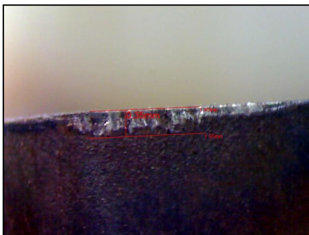
Figura 4.42. Desgaste médio de flanco. LB 2000, vc = 450 m/min, fz = 0,20 mm/rev.
