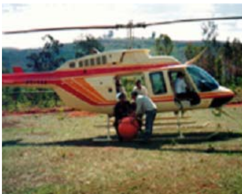
Figura 2.2. Instalação de esferas de sinalização com o auxílio de helicóptero.
