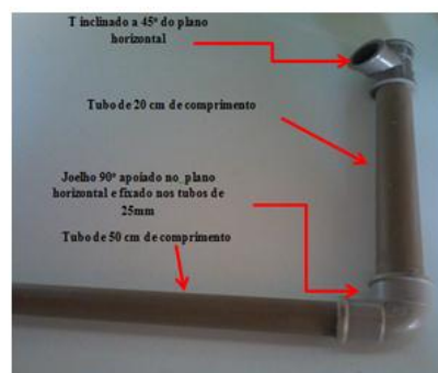
Parte da base alinhada ao solo com o início da montagem da plataforma de lançamento.
