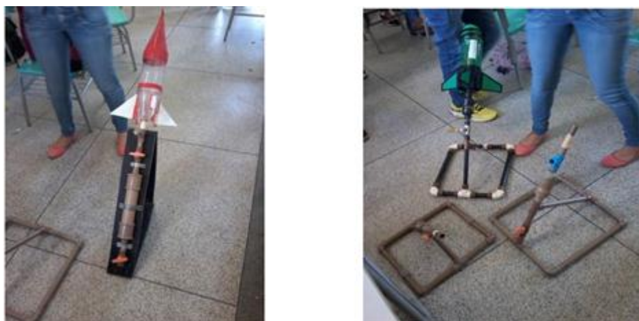
Figura 3 - Bases de Lançamentos para foguetes de ângulos e modelos variados e foguetes de bicos em formas ogiva e cônico – autoria própria
