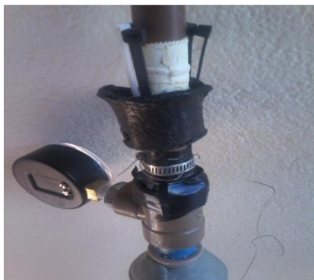
Figura 8 – Gatilho feito de couro ou PVC 40mm usado para travar o foguete quando ele pressiona as presilhas. Autoria própria
