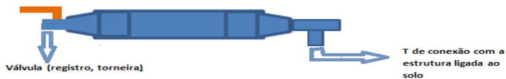
Figura 5 - Reservatório com fixação de válvula
