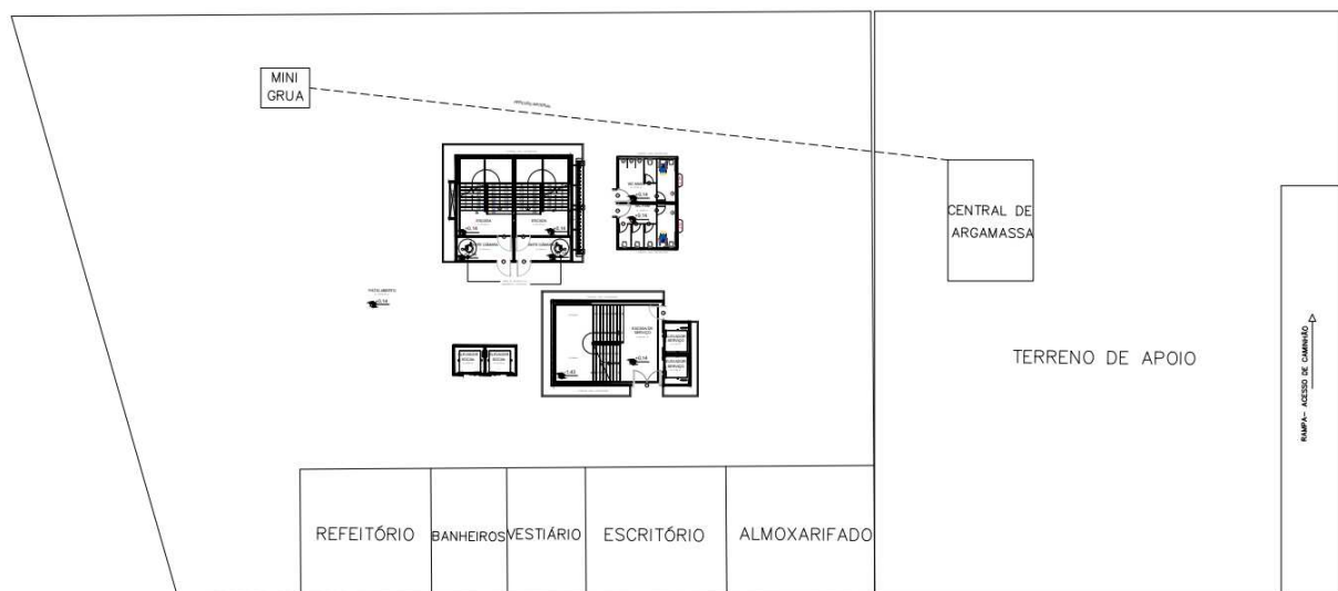
Figura 12 – Canteiro de obra
